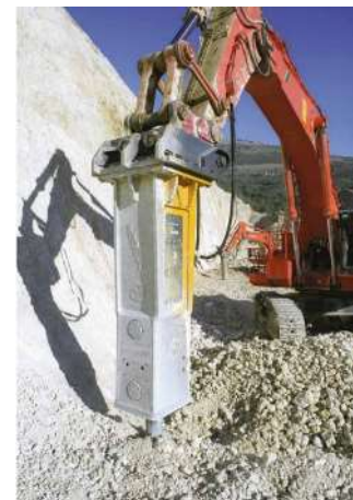
Photo 9 : BRH en extraction de fonds de taille Photo 10 : BRH en extraction en pied de talus
