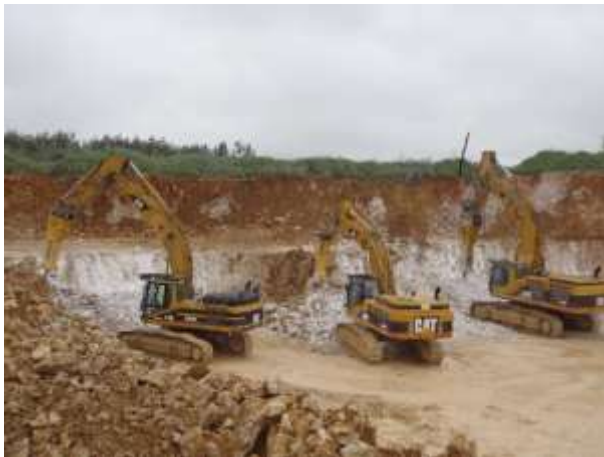
Photo 9 : BRH en extraction de fonds de taille Photo 10 : BRH en extraction en pied de talus
