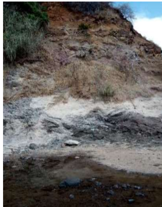
Photo 20 : Falaise présentant de faibles quantités de roches saines en grands blocs avec la présence de couches supérieures altérées ou oxydées
