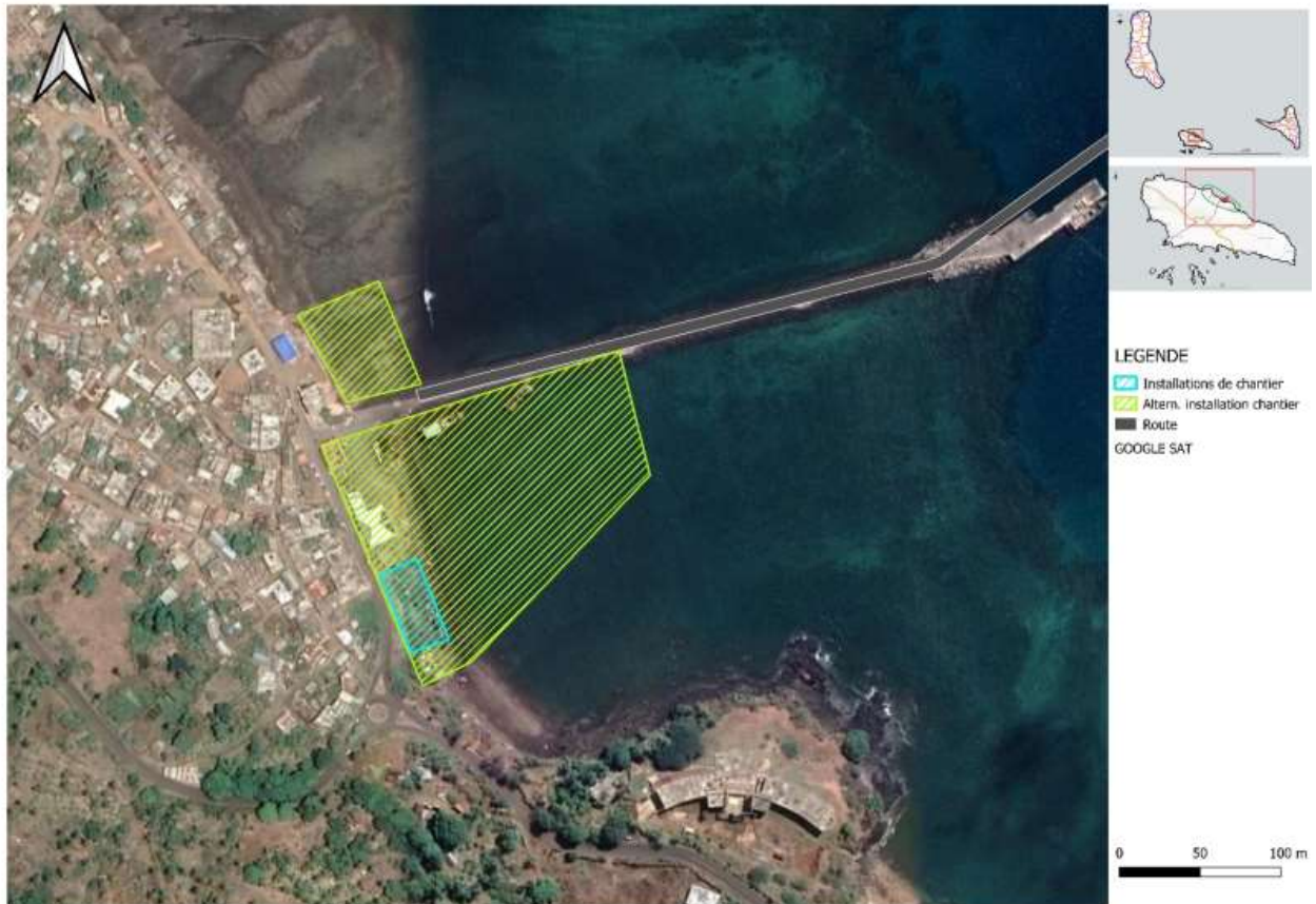
Figure 36 : Site de stockage des produits de dragage à l'intérieur du domaine portuaire
