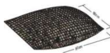
Figure 21 : Pochon en PEHD remplis de galets
